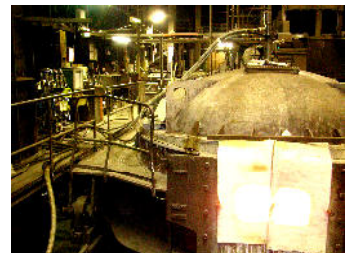
Sintern eines 100 t/Inhalt Warmhalte-Ofens bis auf 1450°C
