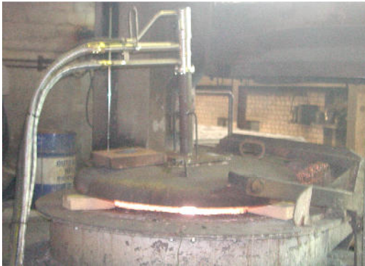
Schnelles Aufheizen eines 6,5t E-Ofens je nach Zustellung in ca. 60 Minuten auf ca. 1200°C
