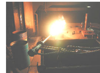
Leistungseinstellung des Oxy-Fuel-Brenners mit UV-Sondenüberwachung und Zündelektrode.
