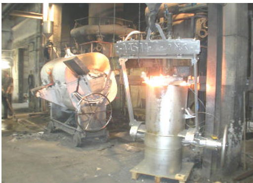
Aufheizen eines Vorherdes und einer Behandlungspfanne bis auf ca. 1250°C in ca. 60 Minuten möglich
