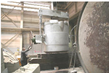
Aufheizen eines Vorherdes und einer Behandlungspfanne bis auf ca. 1250°C in ca. 60 Minuten möglich
