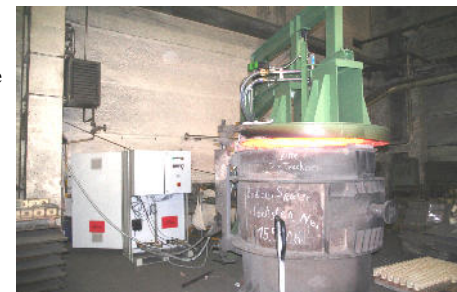
Pfanne 8 t/Inhalt Aufheizen in ca. 60 Minuten auf ca. 1200°C. Transportable Regelanlage 3-stufig. Erdgas ca. 30m 3 /h + O 2 ca. 60m 3 /h
